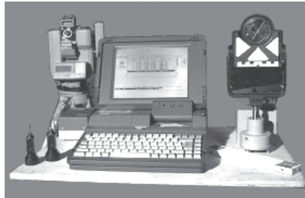
Abbildung 1: Tachimeter mit CAD-System
