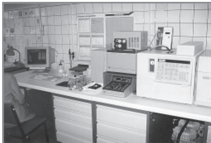
Abbildung 16: Gaschromatograph und Massenspektrometer (IEMB)
