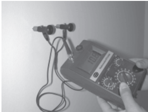
Abbildung 7: Feuchtemessung, Widerstandsverfahren (IEMB)
