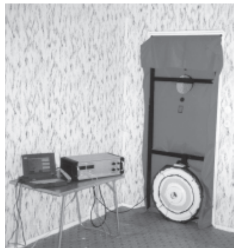
Abbildung 14: Blower Door (IEMB)
