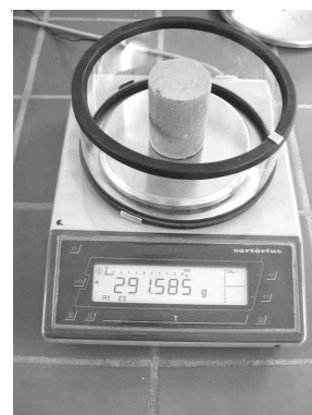
Abbildung 9: Präzisionswaage zur Masseverlustermittlung (IEMB)
