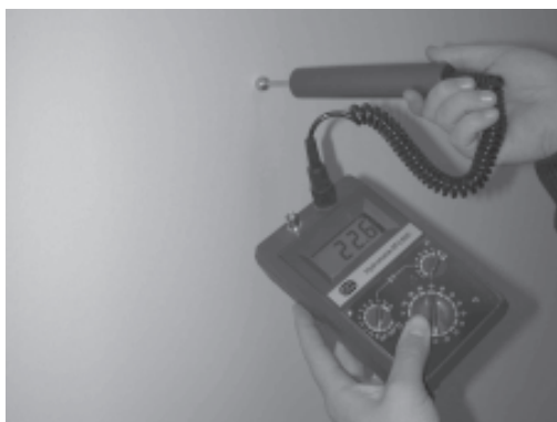
Abbildung 8: Feuchtemessung, Dielektrizitätskonstante (IEMB)
